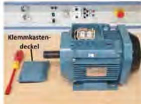
1. Schrauben Sie den **Klemmkastendeckel** mit einem geeigneten Sechskantschraubenzieher auf und nehmen Sie ihn ab.
