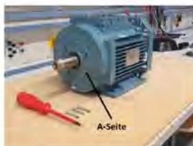
5. Entfernen Sie die **3 Schrauben** des **Fettkammerdeckels** auf dem Lagerschild der A-Seite. Viele Motoren haben keinen Fettkammerdeckel.
