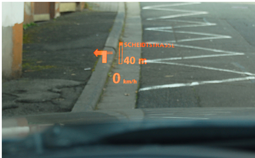
Abbildung 1.3: Head-Up Display eines BMWs. Foto: Sebastian Klein/Wikipedia
