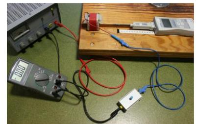
Abbildung 2 Hallsonde, Spule, Netzteil und Voltmeter
