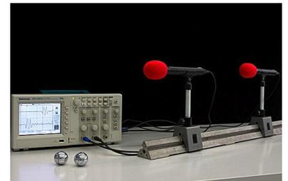
Abbildung 1 Oszilloskop mit Mikrofonen
