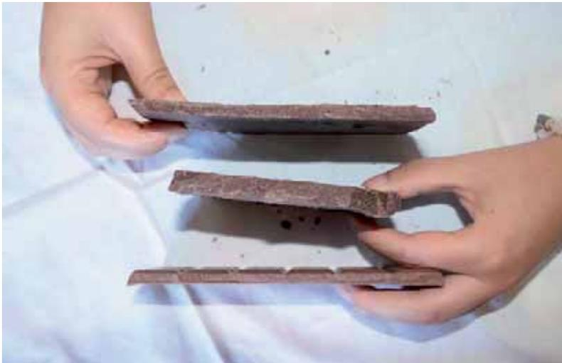
Abb. 19: Vergleich der Milka-Alpenvollmilchschokolade (links) mit der nicht conchierten Schokolade aus Versuch 1 (mittig) und der conchierten Schokolade aus Versuch 5 (rechts) aus der Seitenansicht (eigene Abb.)
