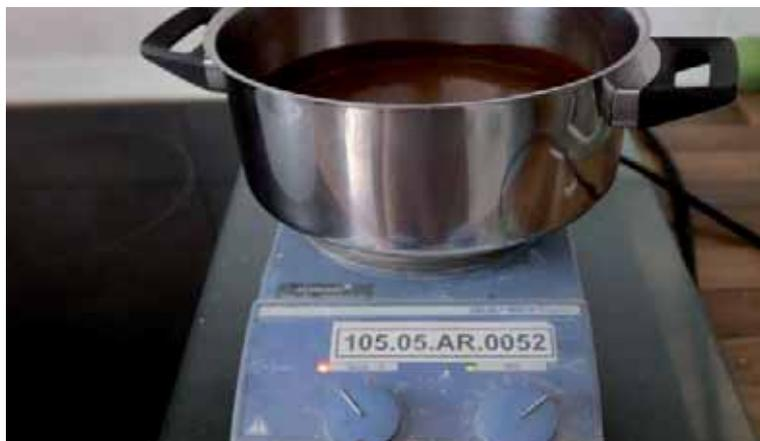
Abb.11: Trockenconchieren der Schokoladenmasse im ersten Versuch (eigene Abb.)
