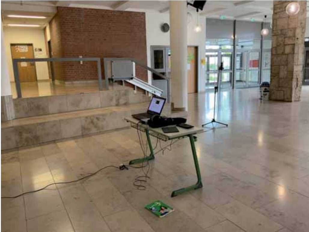
Abbildung 19: Versuchsaufbau in der Aula mit Mikrofonposition 2 43
