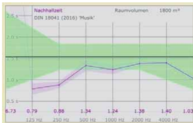
Abbildung 7: Vergleich der Messung mit der DIN 18041
