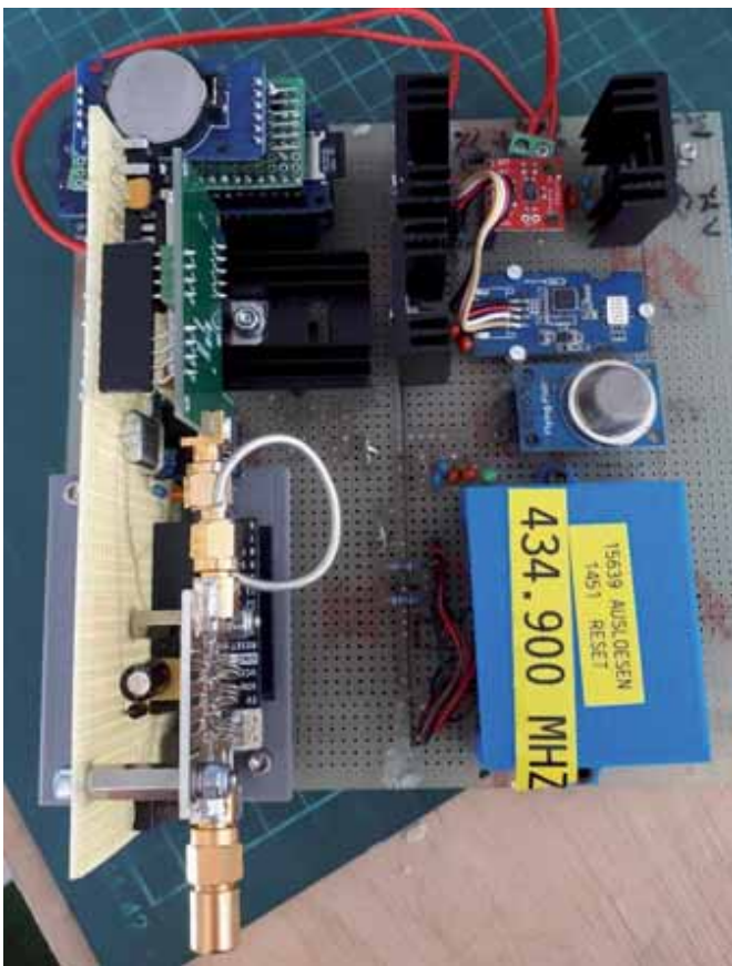
Abb. 6: Aufbau der Platine: Links oben: Arduino MKR WiFi 1010, darüber MKR SD Shield und DS3231 Real Time Clock Rechts von oben nach unten: CCs811, MiCS6814, MQ135, PMS5003
