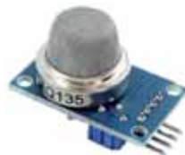
Abb. 4: MQ135 misst NH_3 , NO_x , Ethanol, Benzol, Rauch, CO_2
