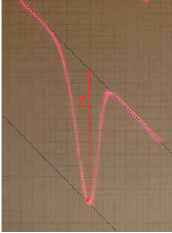
Abbildung 13: Foto der Diffusionskurve und Auswertungsverfahren
