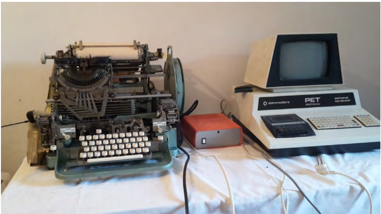
Abbildung 4: Der Fernschreiber mit einem Commodore PET, verbunden über ein Modem.
