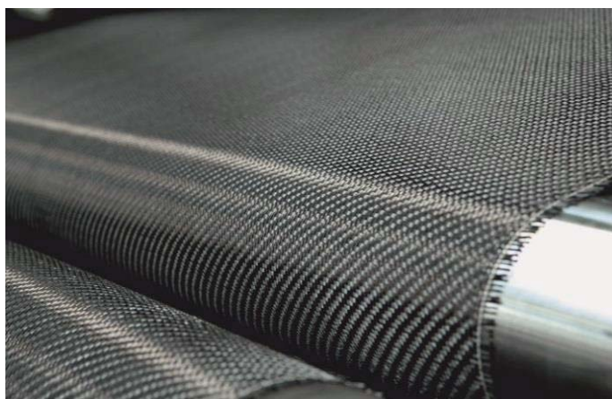
Abb.2 Herstellung von Carbonfasergewebe
