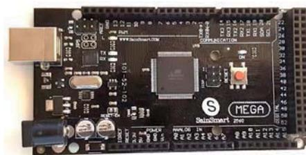
Abb.16 Mikrocontrollerboard MEGA 2560.<sup>2)</sup>
