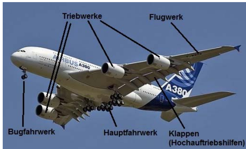
Abbildung 5 Fahrwerk, Flugwerk, Triebwerk am Airbus A380 nach http://www.aerospaceweb.org/aircraft/jetliner/a380/a380_16.jpg
