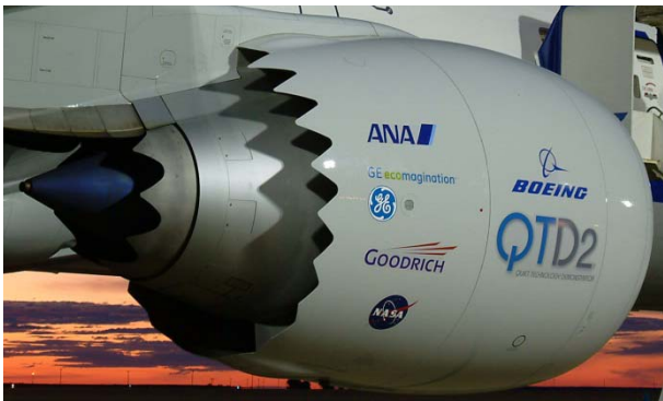
Abbildung 15 Chevron-Düse (die Luft strömt von rechts nach links); [12]
