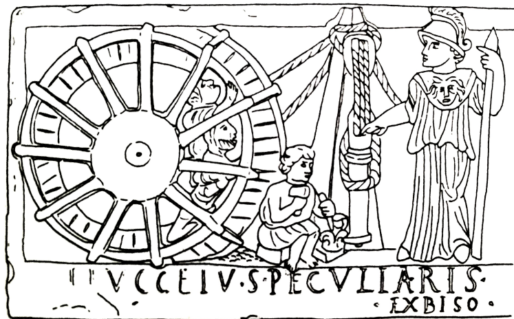
Abbildung A.4.: Bodenperspektive auf Arbeiter, die durch Schwerstarbeit in der Seiltrommel eine Säule heben. Ein gut gekleideter Mann beaufsichtigt das Heben der Last. Weihrelief aus Capua. [Schürmann 1991, Kapitel 3.4, Die Krane in Vitruvs „De architectura“, S. 152, Verweis dort: „Adam, Construction, Abb. 92, S. 48.“].
