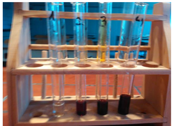
Abb. 25: Ergebnis des Eisennachweises in den aufgeschlossenen Bodenproben, 07.02.14, Bildquelle: Elisabeth Hilger
