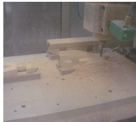
Abbildung 8: Modell beim Fräsen
