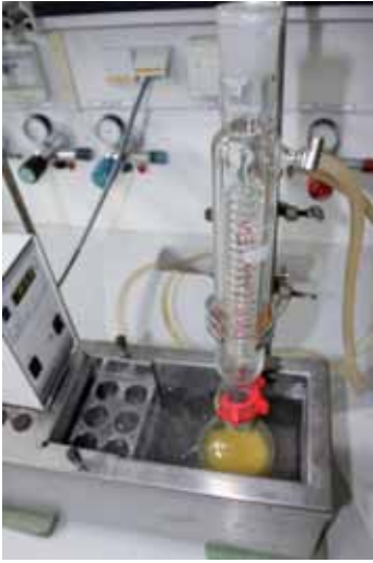
Abbildung 7: Sinigrinextraktion im Wasserbad mit Rückflusskühler
