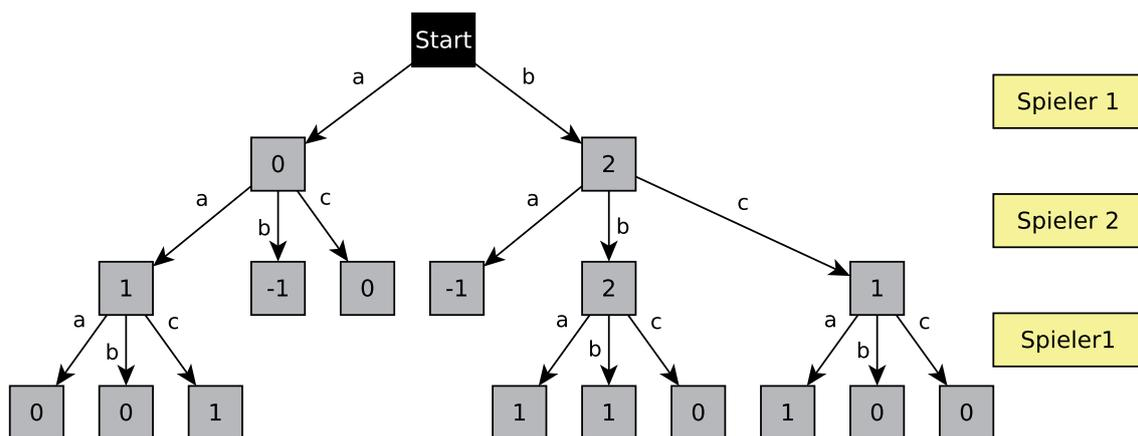
**Abbildung 8** Für Spieler 1 ist laut dem „SummenAlgo“ Zug b sinnvoller, da der Positionswert mit 2 höher ist als bei Zug a.
