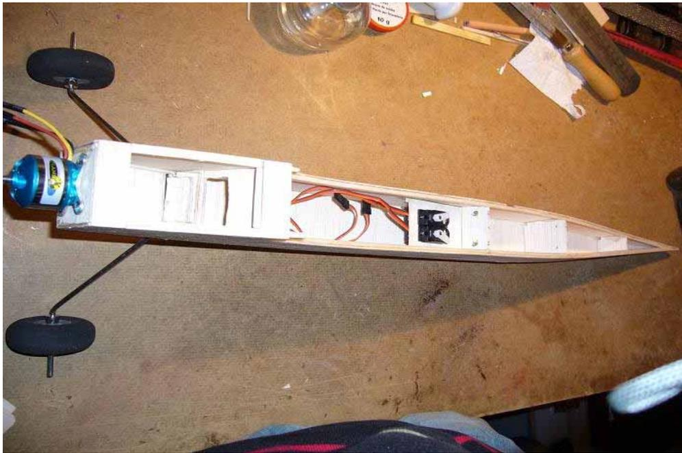
Nun müssen die zwei Servomotoren (= „Servos“) für Seiten- und Höhenruder angebracht werden. Diese werden nebeneinander in ein 1,5mm dickes Sperrholzplättchen mittig geschraubt. Hierbei müssen die Servoarme (auf der Abbildung in weiß) um ein paar Millimeter gekürzt werden, da sie sonst an der Wand anschlagen.
