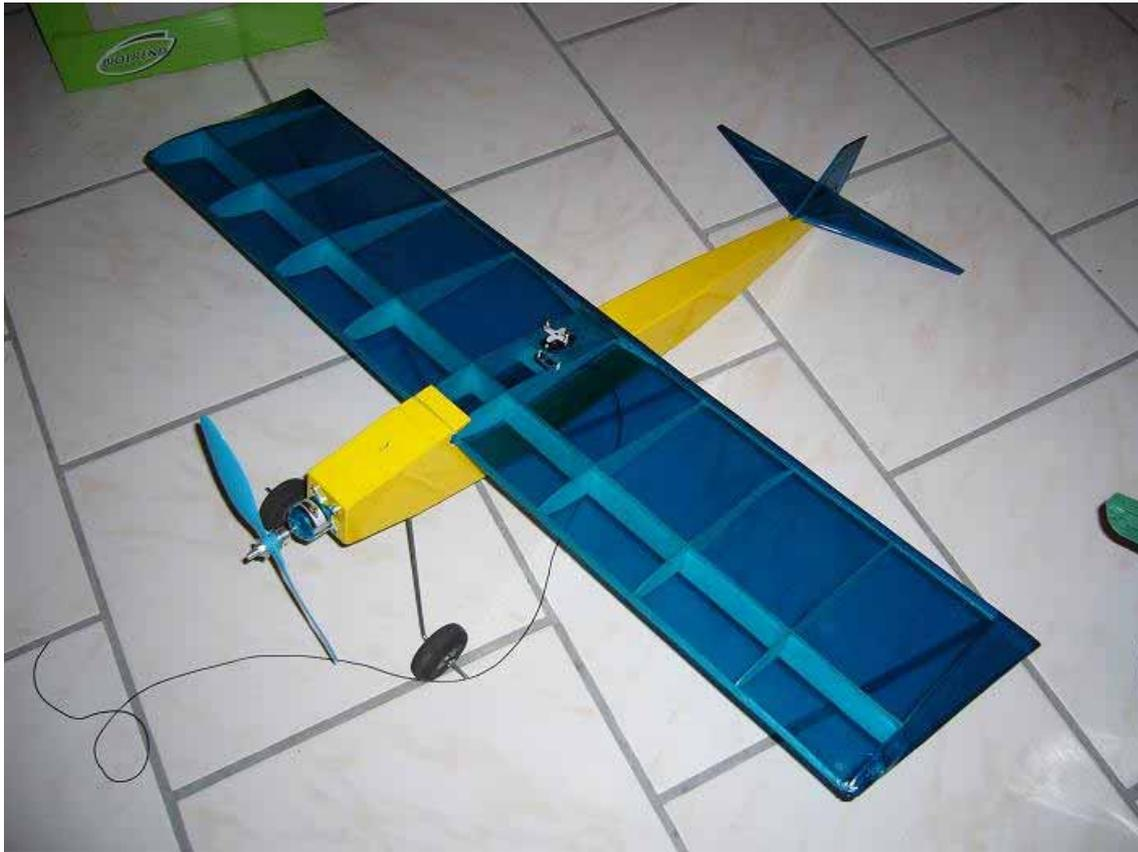
Der letzte Schritt ist eigentlich am einfachsten und auch am Besten zu genießen: Die Quer-, Höhen und Seitenruder werden mit je einem Streifen Paket-Tesafilm von der Unterseite und mit einem Streifen von der Oberseite angeklebt um ein Scharnier zu erhalten. Hierbei sollten die Abstände zwischen Ruder und Leitwerk, bzw. Fläche, in etwa 3mm betragen.
