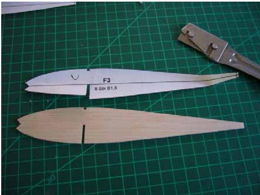
Diese wurden hauptsächlich mit Weißleim und Sekundenkleber an der Verbindungsleiste befestigt. Der Vorteil dieser Klebstoffe gegenüber dem weitaus härteren Zwei-
