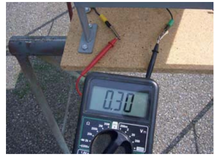
Abb. 23: Vorgang der Stromflussmessung
