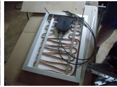
Abb. 62: Kühlkreislauf hinter der Zelle mit Metallschienen fixiert
