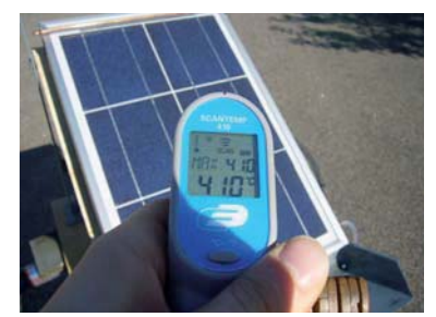
Abb. 45: Oberflächentemperatur der Solarzelle
