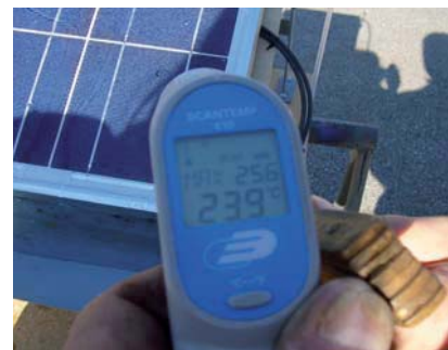
Abb. 55: Oberflächentemperatur nach dem Versuch
