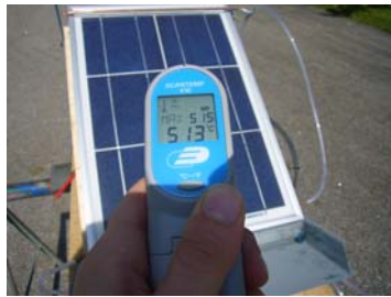
Abb. 69: Oberflächentemperatur vor dem Versuch
