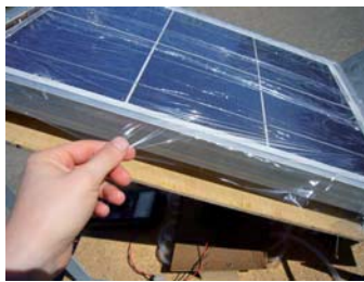
Abb. 27: Folie beim Aufziehen auf die Solarzelle
