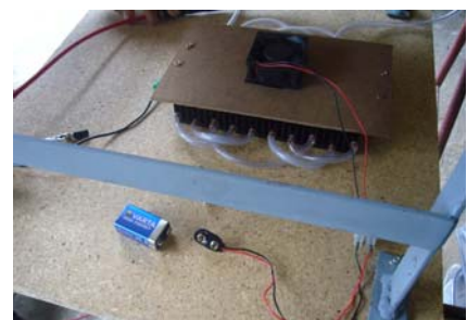
Abb. 66: Wärmetauscher mit Kühl- leitungen und Ventilator
