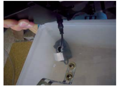
Abb. 42: Loch für das Verbindungskabel im Behälterdeckel
