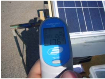
Abb. 56: Oberflächentemperatur vor dem Versuch
