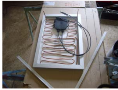
Abb. 61: Kühlkreislauf hinter der Zelle
