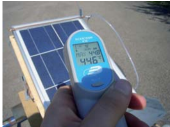
Abb. 83: Oberflächentemperatur vor dem Versuch
