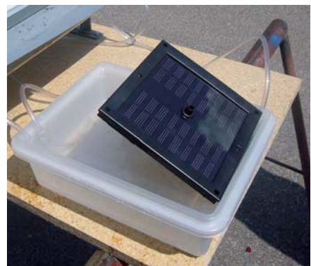
Abb. 39: Solarzelle der Wasserpumpe auf dem Wasserbehälter
