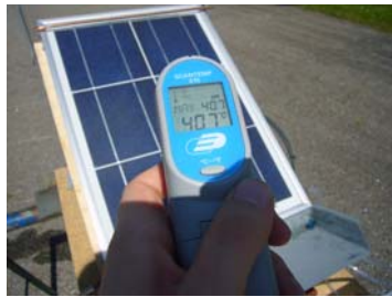
Abb. 71: Oberflächentemperatur nach ca. zwei Minuten
