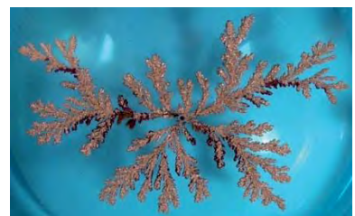
Abb. 20: Ein bei der elektrolytischen Abscheidung von Kupfer aus einer Kupfersulfatlösung entstandener Dendrit
