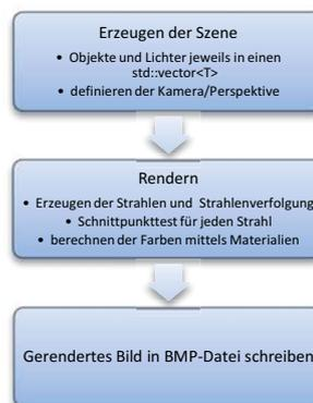
Abbildung 6: Funktionsweise des Raytracers
