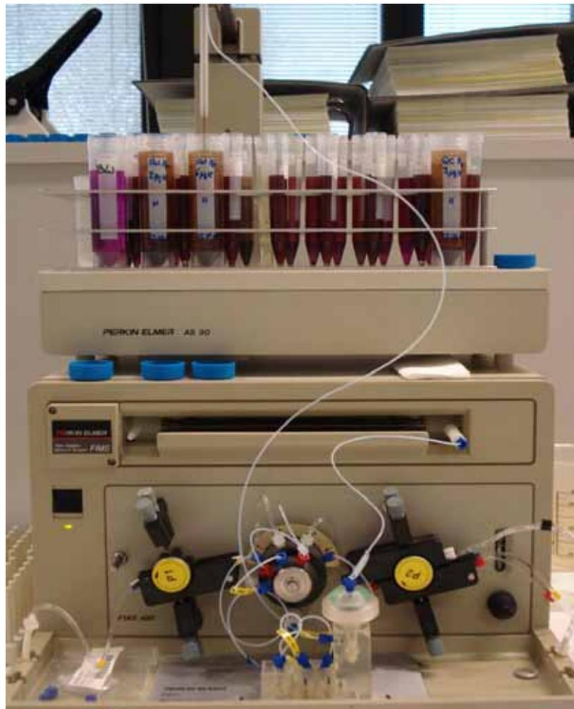
Abbildung 12: Messgerät FIMS (1)
