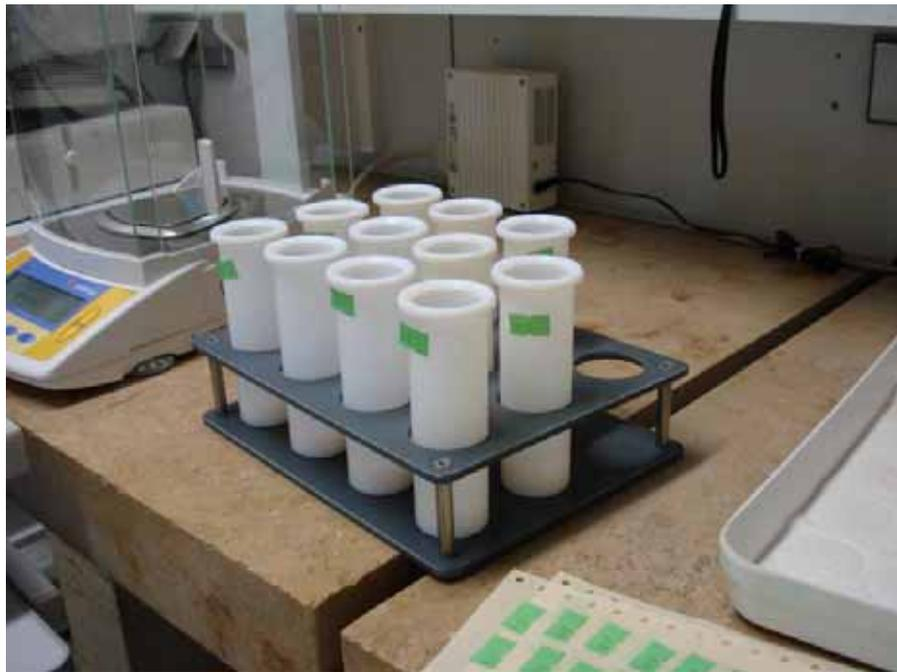
**Abbildung 6:** Teflon-Gefäße für den Aufschluss <sup>(1)</sup>
