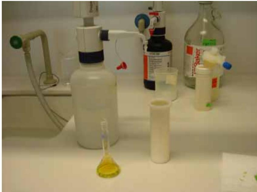
**Abbildung 9:** Probe nach Aufschluss <sup>(1)</sup>
