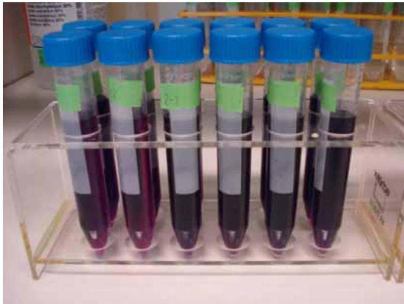
**Abbildung 10:** Fertige Proben zur Messung der Quecksilbergehalts <sup>(1)</sup>
