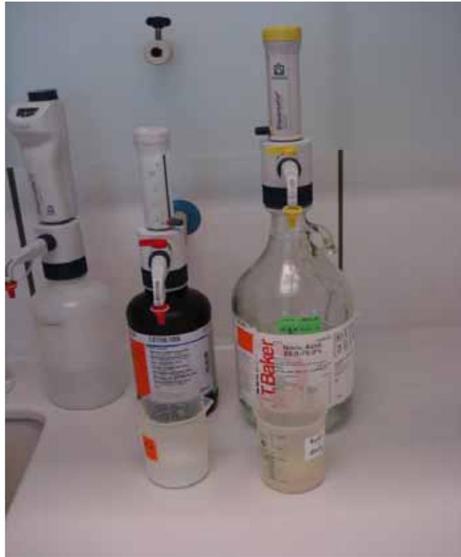
**Abbildung 7:** Wasserstoffperoxyd und Salpetersäure für den Aufschluss<sup>(1)</sup>
