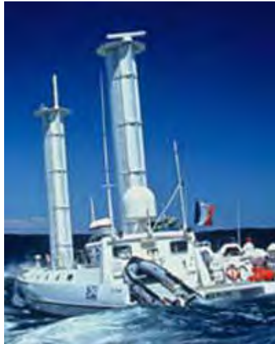
Bild 2.1 Flettner-Rotor auf einem Segelboot
