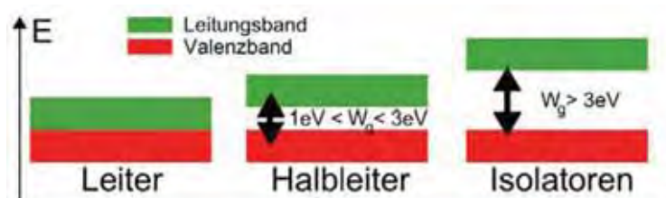
Abbildung 3: Bandstruktur von Leitern, Halbleitern und Isolatoren
