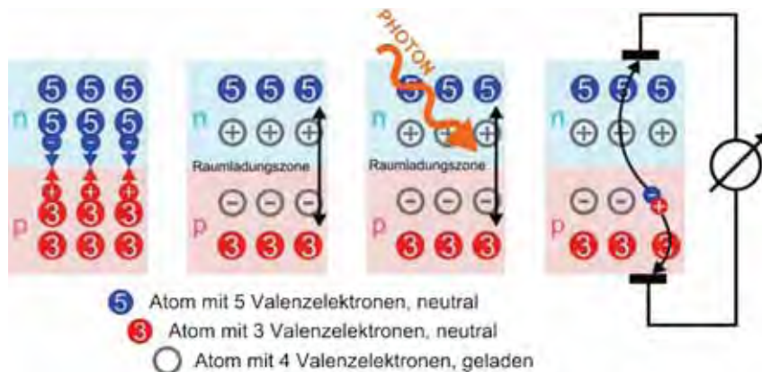
Abbildung 6: Bildung von Raumladungszone und Elektron-Loch-Paaren
