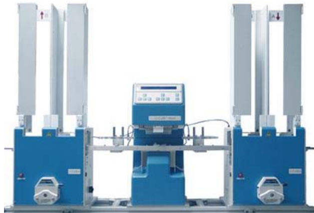
384- Kanal Simultanpipettierer der Firma Cybio
