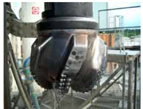
Abb.7: Bohrmeisel mit 24 Zoll Durchmesser (Quelle : Knappek)
