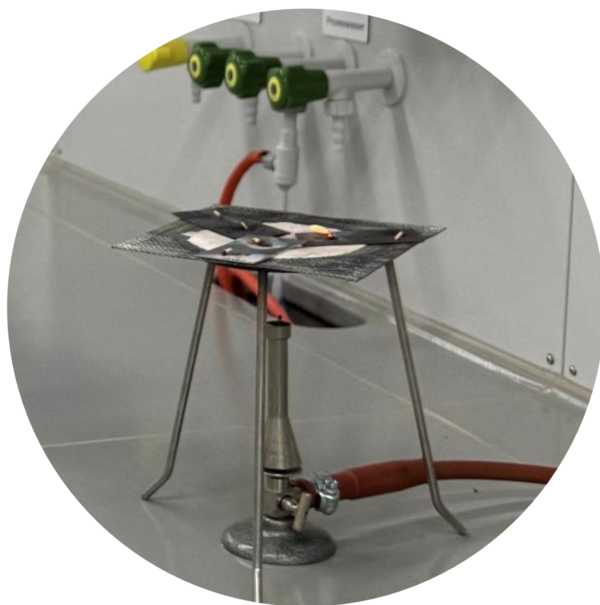
Abbildung: Experimentaufbau zur Wärmeleitfähigkeit von Aluminium
